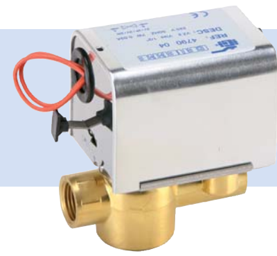
Art. 4790 Válvula Motorizada 2 e 3 Vias Corpo: Latão Forjado Assento: Resiliente Pressão: 0 a 2 Bar Temperatura: 0 a +94°C Conexão: 1/2" a 1"
