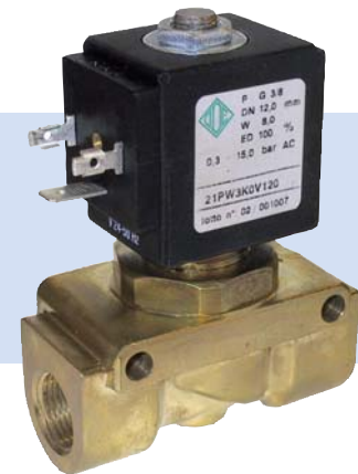
Art. 4019 03/04 Corpo: Latão Assento: Pistão PTFE Pressão: 0,3 a 25 Bar Temperatura: -10 a +180°C Conexão: 3/8" a 1/2"
