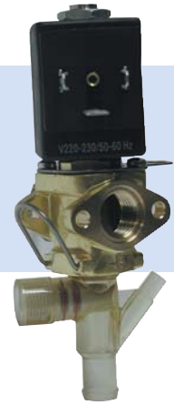
Art. 4250 Normalmente Fechada Corpo: Polisulfone (PSU) Assento: Silicone Pressão: 0 a 0,3 Bar Temperatura: -10 a +80°C Conexão: 1/4"
