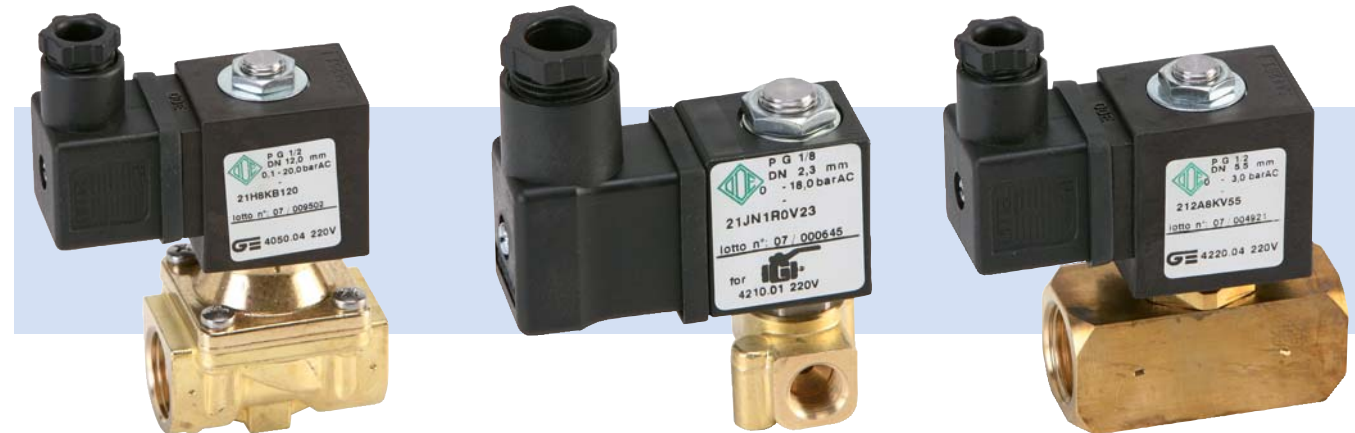
Art. 4050 Normalmente Fechada Corpo: Latão Assento: Diafragma Pressão: 0,1 a 20 Bar Temperatura: - 10 a +140°C Conexões: 3/8" a 1"
