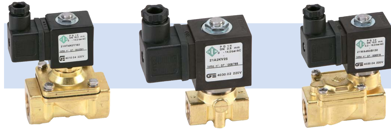
Art. 4010 Normalmente Fechada Corpo: Latão Assento: Diafragma Pressão: 0 a 14 Bar Temperatura: - 10 a +140°C Conexões: 3/8" a 1" P/ CC utilizar bobina de 14W
