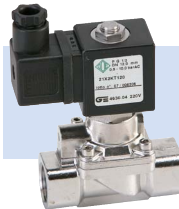
Art. 4630 Normalmente Aberta/Fechada Corpo: Aço Inox AISI 316 Assento: Resiliente Pressão: 0,3 a 10 Bar Temperatura: +60 a +180°C Conexão: 1/4" a 1"
